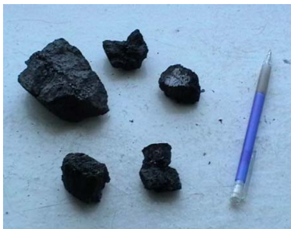
Рис. 2. Полукокс, получаемый на установке пиролиза
